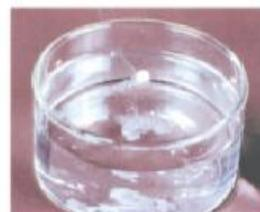
réaction du potassium avec l'eau figure (5)
