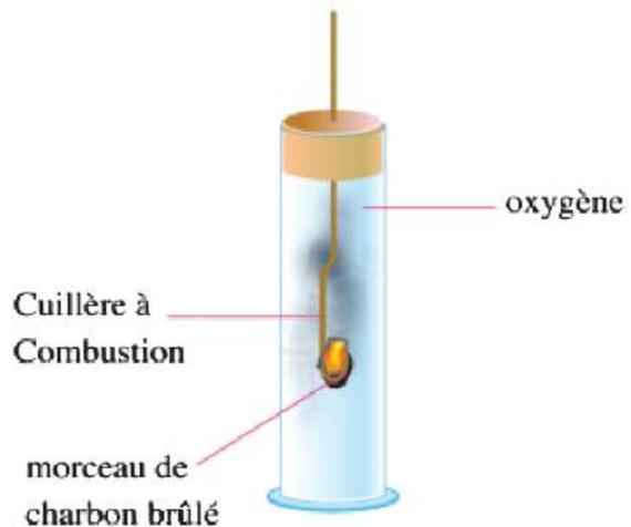
combustion du charbon dans l'oxygène
