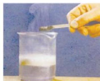
réaction du magnésium avec l'acide chlorhydrique figure (6)
