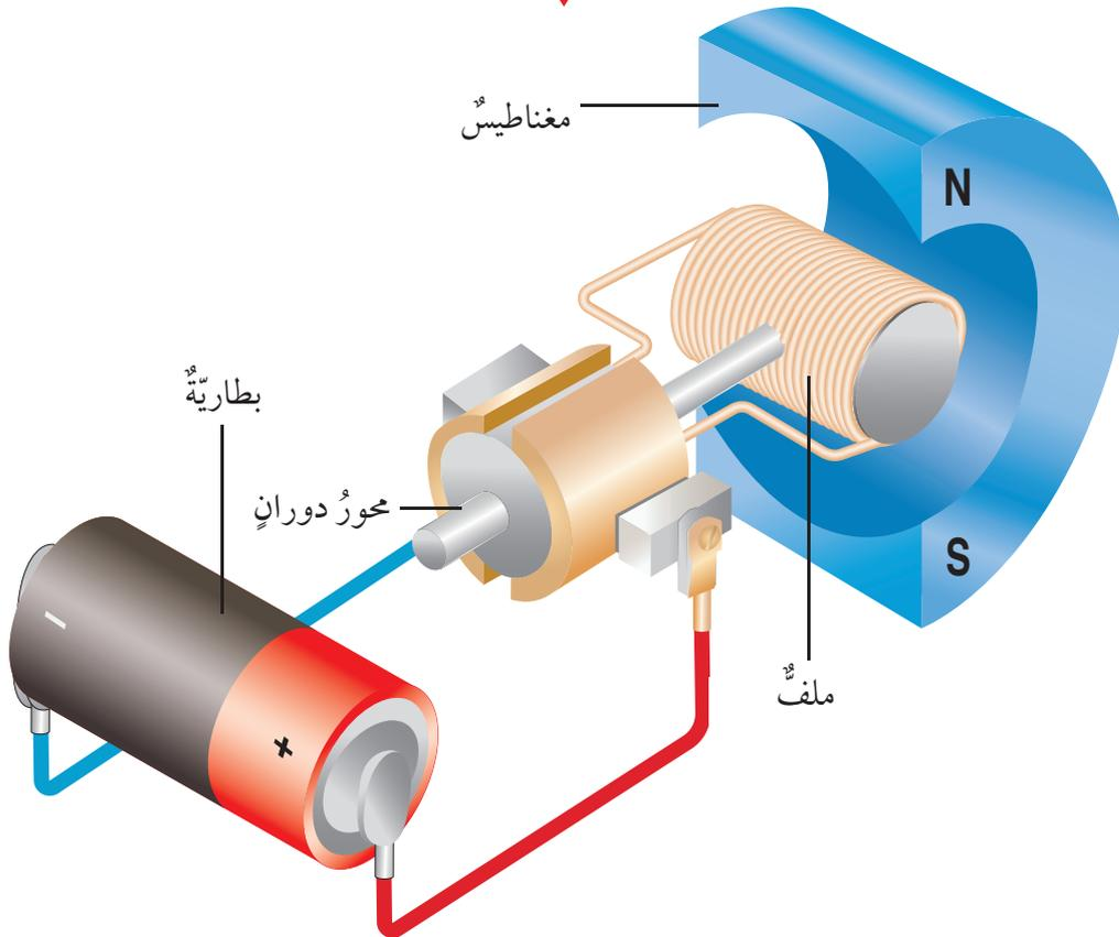
الشكل (9): في المحرك تتحوّل الطاقة الكهربائية إلى طاقة حركية.
