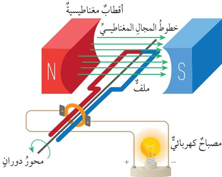
الشكل (12): نموذج المولّد الكهربائيّ.
