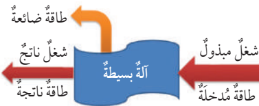
الشكل (13): تحولات الطاقة في الآلة البسيطة.
