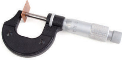
الشكل (3): قياس سُمْكِ صفيحة باستخدام الميكروميتر.
