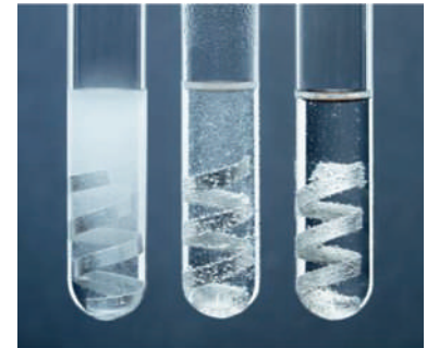
الشكل (3): تفاعل فلزّ المغنيسيوم مع حمض \text{HCl} .
