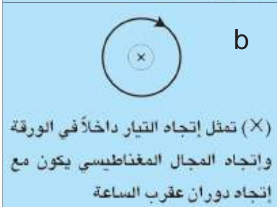
الشكل (9) اتجاه المجال الكهربائي والمجال المغناطيسي
