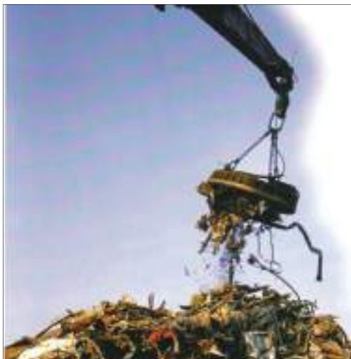
الشكل (18) مغناطيس كهربائي يستعمل لرفع
