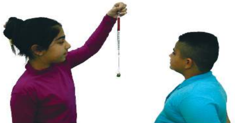
▲ يعلق الميزان النابضي بصورة عمودية عند قياس وزن الجسم
