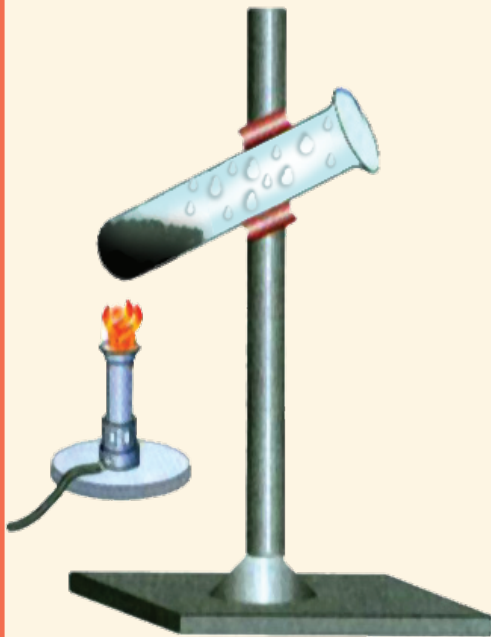
شکل (۱-۳) دستگاه تشخیص کاربن و هایدروجن
